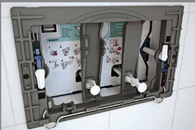
↑ Einfach werkzeuglos: Befestigungsrahmen für die Betätigungsplatte ohne Schrauben befestigen. Drückerstangen einschieben, um 90° drehen und mit Keil fixieren.
