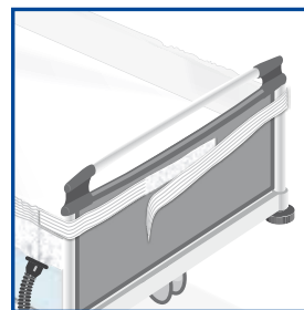
2. Die wasserdichte Matratzenwanne wird mit Klettbindern am Bettrahmen befestigt.
