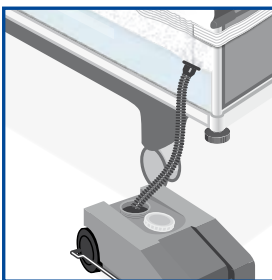
3. Der Abwasserschlauch wird am Abwasserwagen angeschlossen.
